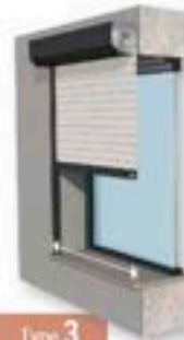
Type 3 Pose en applique en façade
