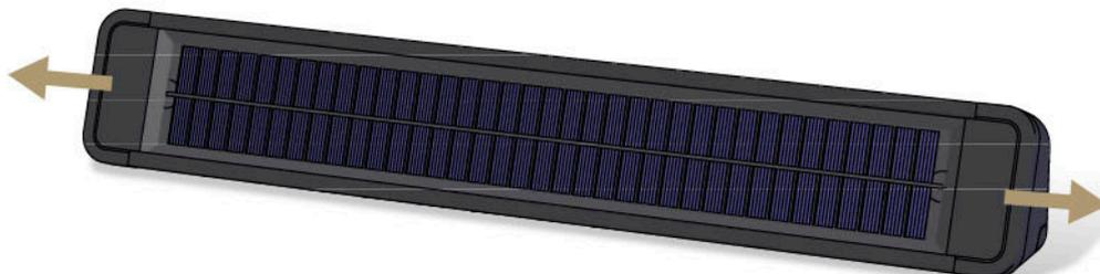
Fixer le support du panneau solaire au travers des deux pièces plastiques (Sortie des fils à droite)
