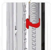
Réglage de ressort par console basse avec crans (numéro de cran notifié en bas du rail grâce à une pastille : degré de liberté = +1/-1)
