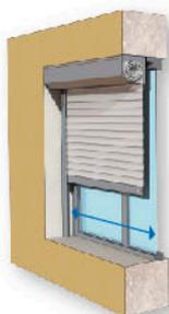
**Pose sous linteau enroulement extérieur.**
