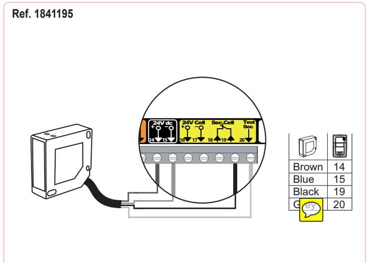
**Barre palpeuse filaire optique - Dipswitch 4 récepteur sur OFF**
