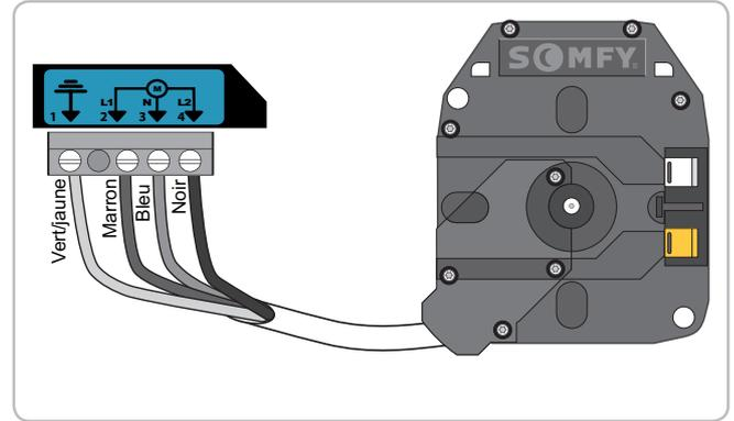
[2]. Bloquer le câble moteur avec le serre-câble fourni.
