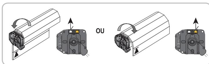
[8]. Appuyer simultanément sur les touches ▲ et ▼ ou appuyer sur la touche Prog jusqu'au mouvement de va et vient du moteur pour sortir du mode réglage moteur. Le voyant 1 s'éteint.
