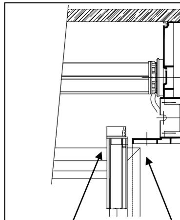
**Attention, la base des tulipes, doit être de même niveau et alignée avec l'intérieur de la joue.**
