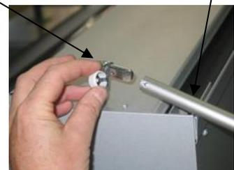
Retirer la vis qui se situe à l'extrémité du 6 pans et retirer la bague de la manivelle
