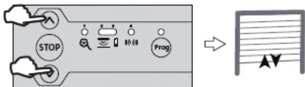
Appuyer sur le bouton STOP jusqu'au mouvement de la porte.
