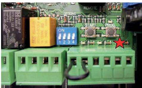
Vérifier que le stop chute est correctement branché aux bornes 18 et 19 (IN3).
