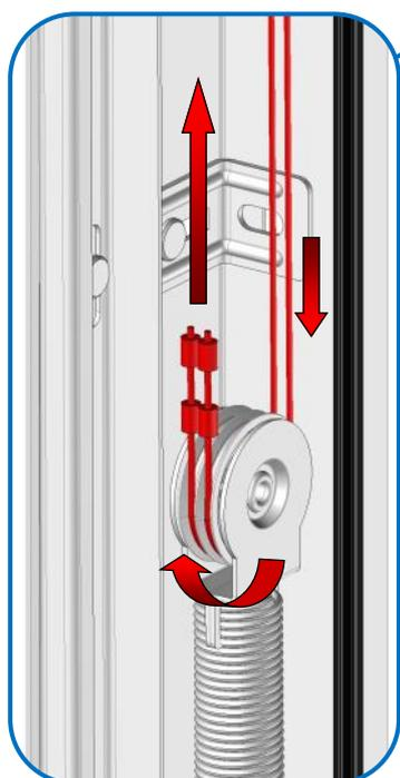
Tourner le crochet vers la console de réglage.
