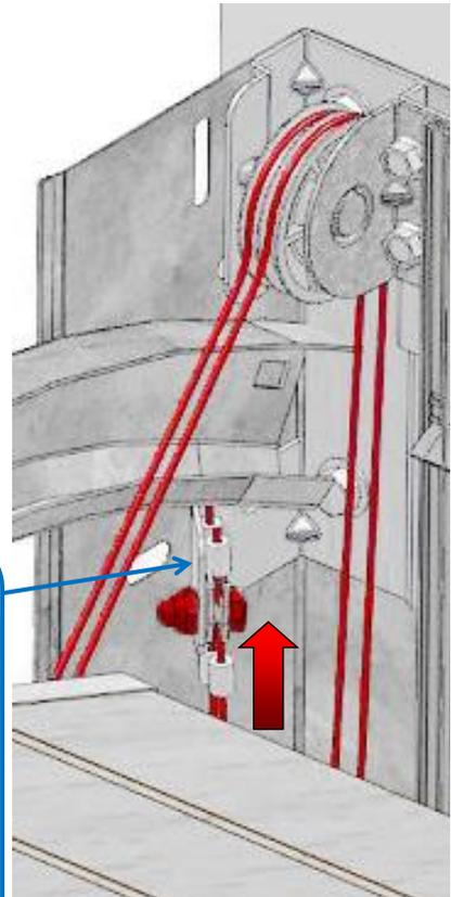
**Important :** Serrer légèrement le boulon, la plaque doit pivoter librement.
