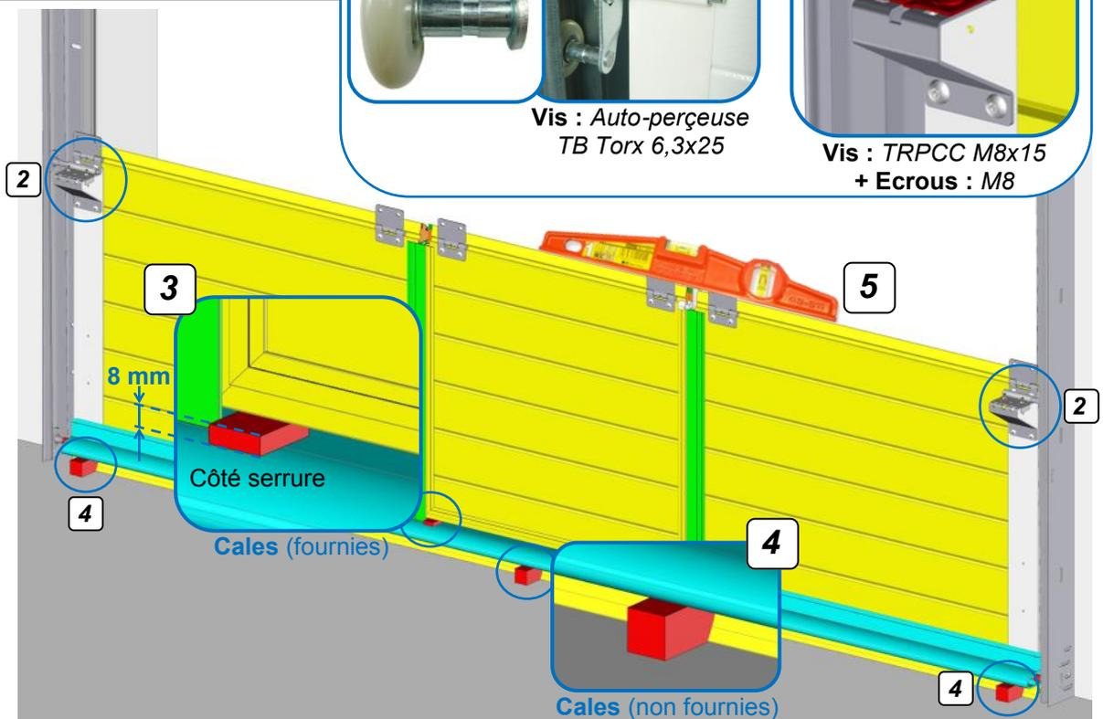
**! Pour installer le panneau bas de niveau, mettre des cales suffisamment hautes en appuie sous le seuil pour éviter l'écrasement du joint bas lors du montage des panneaux suivants.**
