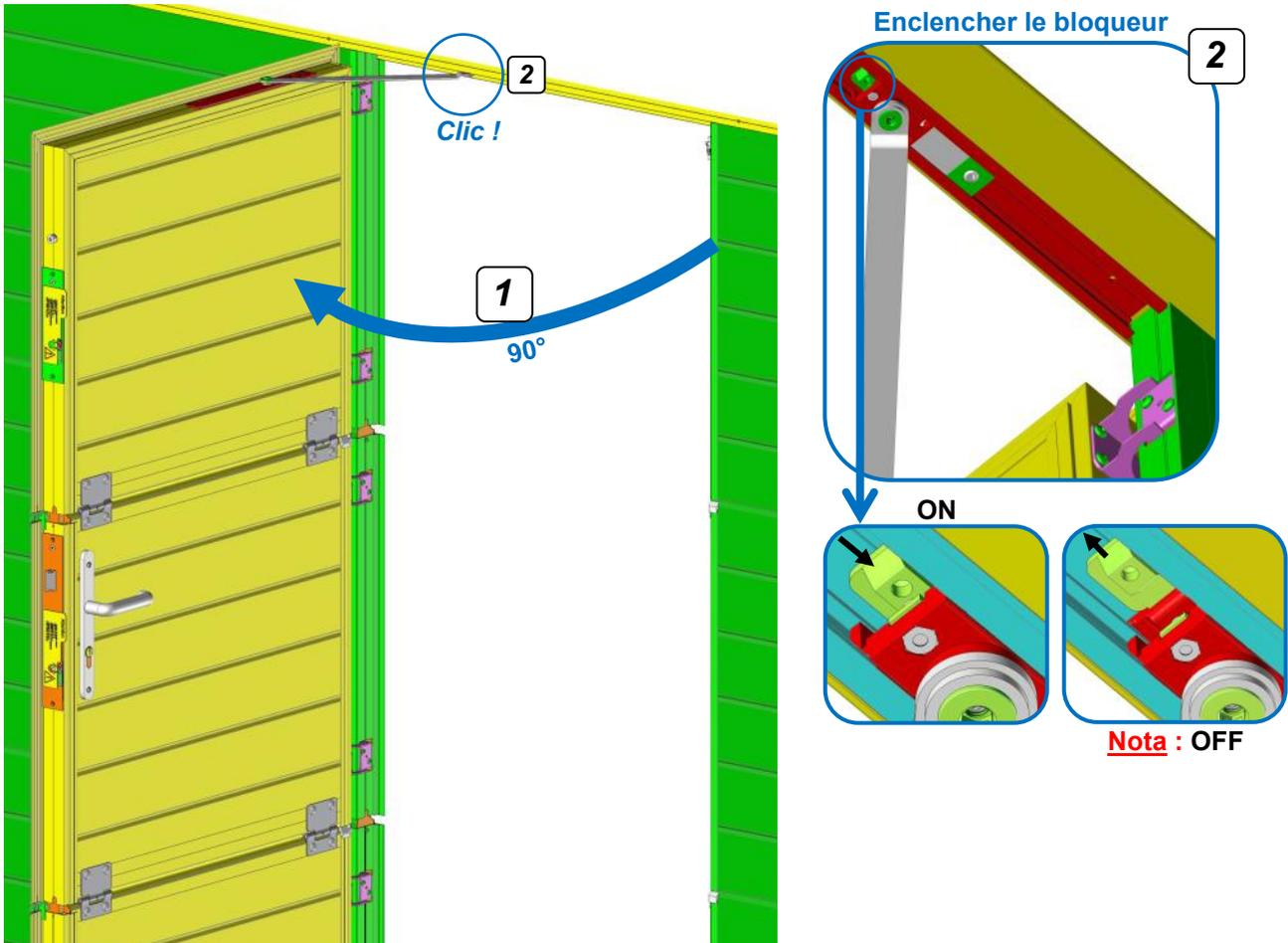
**Tester le module d'arrêt :** (blocage du portillon à 90°)
