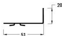
REA630 Patte de Reprise Dormant 60 mm 204010188 A partir de 1700 mm Dos de Coulisse
