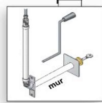
Kit d'accès à la manœuvre de secours par l'extérieur avec traversée de mur protégée par une plaque avec serrure à clé
