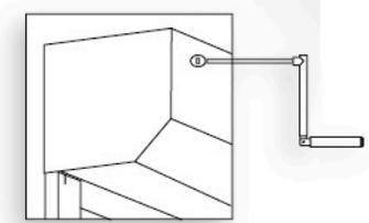
Kit d'accès à la manœuvre de secours par l'extérieur sur la face avant du caisson avec serrure à clé
